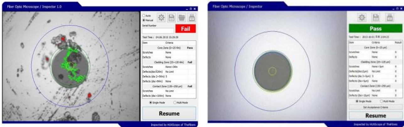
Programvare for automatisk pass/fail analyse i hht. IEC 61300-3-35
